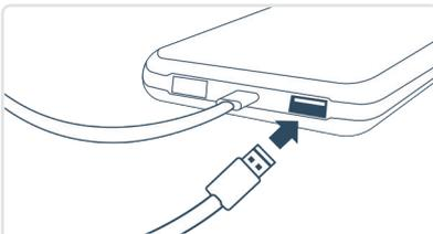
Schließen Sie das USB Kabel an den PowerHub an.
