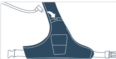
Führen Sie das USB-C Kabel durch den Kabeltunnel des Holsters.
