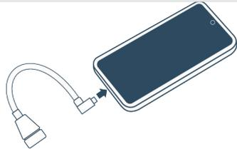
Schließen Sie das USB/USB-C-Kabel (Buchse) an das Gerät an.
