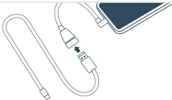
Schließen Sie das USB/USB-C-Kabel (Stecker) an und verbinden Sie es mit der Buchse.
