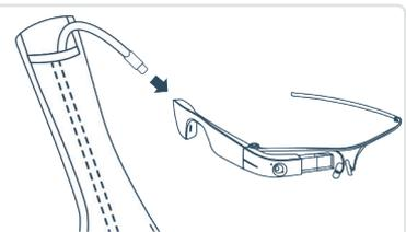
Führen Sie das USB-C-Kabel von unten nach oben durch den Holster und verbinden Sie es mit der Glass EE2. Die Glass EE2 schaltet sich automatisch ein.
