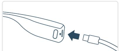
Schließen Sie den USB-C-Stecker an die Glass EE2 an. Die Glass EE2 schaltet sich automatisch ein.
