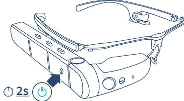
Drücken Sie zur Bestätigung die Taste auf der Rückseite der Vuzix M400.
