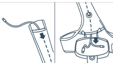
Faites passer le câble Y dans le holster. L'extrémité double vers le bas et l'extrémité simple vers le haut.
